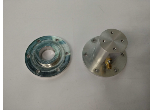
(b) left : New flange. right : Old waveguide
