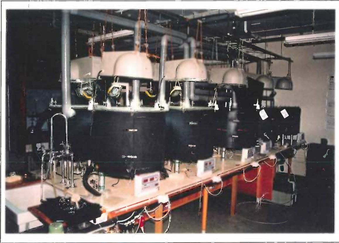
Fig. 2. Opstelling van de begassingstonnen. De glasplaten die de tonnen van boven afdekten en waarboven de lampen hingen, werden met behulp van een ventilator gekoeld. Koelwater zorgde ervoor, dat de temperatuur in de tonnen niet te hoog werd.
